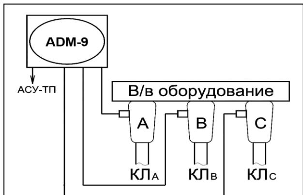
Зарегистрированные акустические импульсы от частичных разрядов обрабатываются и анализируются в приборе «ADM-9», на выходе которого по каждому каналу формируется сигнал, пропорциональный интенсивности частичных разрядов «PDI», учитывающей количество и амплитуду зарегистрированных импульсов частичных разрядов. Полученная информация и диагностические заключения о состоянии изоляции оперативно передаются в систему АСУ-ТП более высокого уровня.
