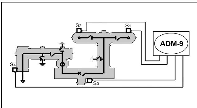
Акустические датчики устанавливаются в зонах, где наиболее вероятно возникновение различных дефектов в изоляции, появление свободных частиц, развитие науглероженных треков. Контролируемая акустическими датчиками зона в КРУЭ обычно не превышает 2 – 3 метров, так как импульсы ЧР в газовой среде быстро затухают, поэтому датчиков требуется достаточно много.
