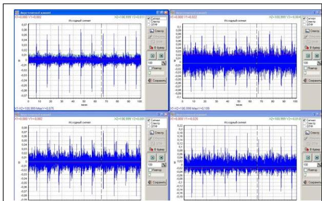
Благодаря хорошей акустической проводимости масла внутри бака в зону чувствительности одного акустического датчика входит достаточно большой внутренний объем изоляции. Это возможно, если на пути движения импульсов к датчику нет экранирующих элементов конструкции трансформатора.
