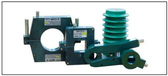
Первичные датчики, предназначенные для контроля частичных разрядов и токов « ${\sf ЧР}$ » и токов утечки в экране « ${\sf I}$ », представляют собой кольцевые трансформаторы тока. Сердечник датчика контроля частичных разрядов изготавливается из высокочастотного феррита, а для датчика тока промышленной частоты используется сердечник из электротехнической стали.
