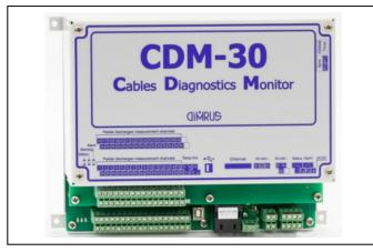
В приборе CDM контроль технического состояния кабельных линий, высоковольтной изоляции соединительных и концевых муфт, осуществляется с использованием метода регистрации и анализа частичных разрядов. Этот метод имеет максимально высокую чувствительность и эффективность для диагностики большинства дефектов в высоковольтных кабельных линиях с изоляцией любого типа.
