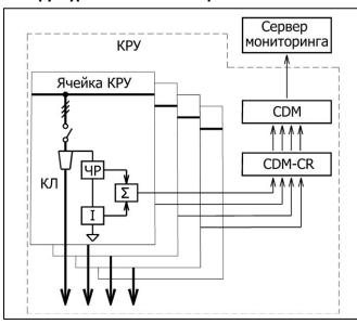
Для практической реализации системы обслуживания кабельных линий ПО техническому состоянию используются приборы CDM-CR, CDM И а также специализированное программное обеспечение мониторинга и диагностики марки INVA. Расположение первичных датчиков, технических и программных средств системы мониторинга КЛ показан на рисунке.
